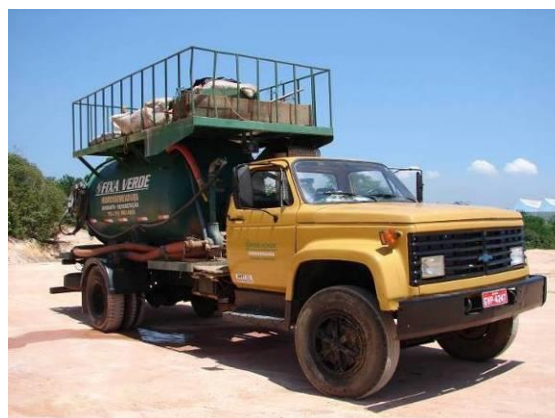
Figura 21 - Caminhão pipa adaptado para hidrossemeadura.
